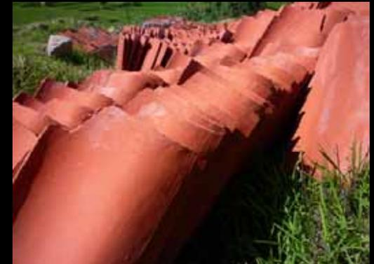
**Tuile de micro béton, énergie grise de 16% inférieure à une toiture en tôle**
